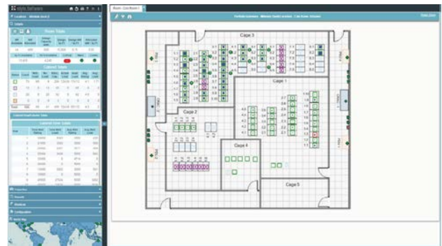
Colocation Room - Centre de données sectionné en zones pour chaque locataire.
